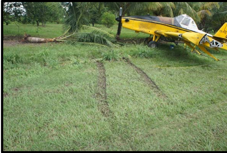
Fotografía No. 13 Trayecto marcado por las ruedas de la aeronave.
