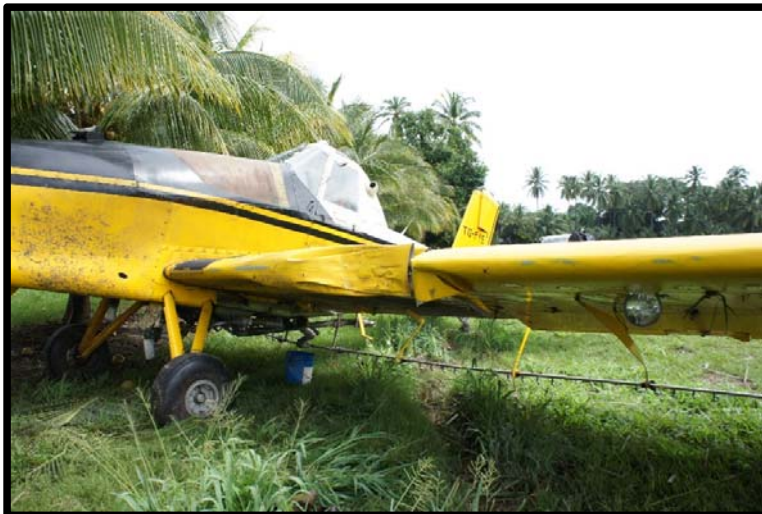
Fotografía No. 10 Vista del daño en el borde de ataque del ala izquierda.
