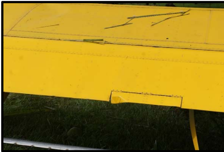
Fotografía No. 8 Daño en la aleta del trim compensador.
